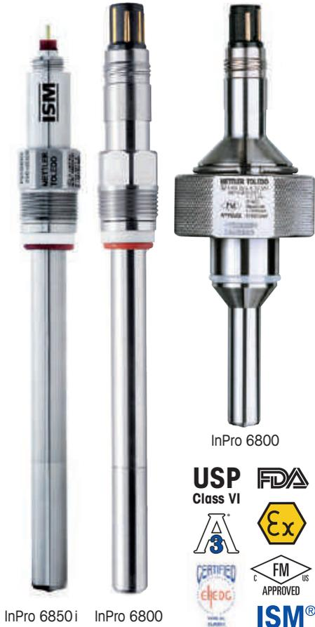
12 또는 25mm 직경 바디를 가진 InPro 6800 용존산소 센서는 제한된 공간을 가진 용기나 더 작은 볼륨의 컨테이너를 위한 최대한의 정확도와 뛰어난 세척능력을 제공합니다. 이 센서를 최신 VP 커넥터 또는 T-82 커넥터에서 직선 또는 각진 형태로 함께 사용할 수 있습니다. 내구성이 있는 316L 스테인리스 스틸 구조로 인해 CIP, 증기멸균(SIP) 또는 오토클레이빙이 허용되며 뛰어난 센서 마감으로 인해 거의 모든 공정 오염이 방지됩니다. Ingold의 PTFE/실리콘 멤브레인은 내부에 스틸 메시가 설계되어 있어 멤브레인이 더 견고해지고 수명이 크게 늘어났습니다.
