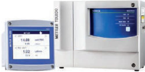
6000TOCi 총 유기 탄소 센서는 실시간 연속 측정을 통해 매 초마다 유기 오염을 즉시 감지할 수 있으며, 검증된 UV 산화 기술을 이용하여 중요한 용수 시스템을 실시간으로 TOC 모니터링할 수 있습니다. RO 후단 용수에서 POU 사용 시점까지 TOC 수준을 쉽고 효율적으로 모니터링하여 일탈을 절대 놓치지 않습니다. 사용자를 염두에 두고 설계된 직관적인 인터페이스와 유연한 Plug and Measure 방식이며 작동에 시약이나 화학물질이 필요하지 않습니다.
